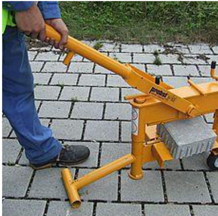
Foto N° 2: Partidora de adoquines, se puede reemplazar por sierras circulares, amoladoras de disco o puntualmente por cinceles.
