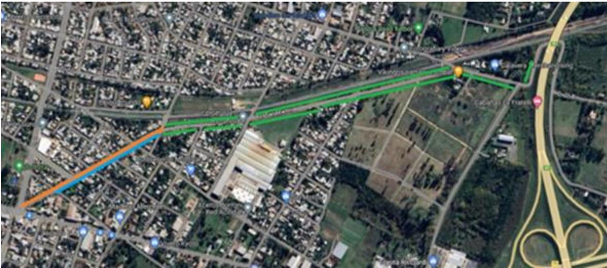
Figura 6. En naranja, el tramo a pavimentar. En verde, el tramo correspondiente a limpieza y perfilado de zanjas. En azul, el pluvial proyectado.
