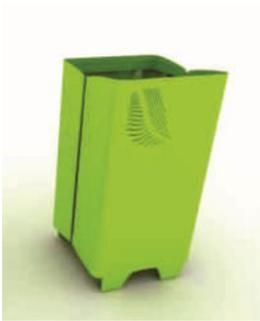
Cesto de chapa de 3.2 mm de espesor, con base de chapa reforzada y pie de UPN 100. Conformado por dos piezas, separada generando un prisma rectangular de 45 x 45 cm y cuatro patas de apoyo proporcionando una altura desigual, con un máximo total de 88 cm.
