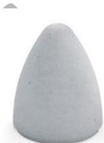
Bolardo de H° A° (peso mayor o igual a 90 kg), con formato tipo "bala", de diámetro de base 30 cm y altura 40 cm. Color, gris plomo, terminación pulido.
