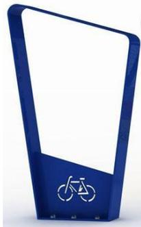
Bicicletero de chapa de acero 3/16 y planchuela de 3" x 3/16. Medida de la base inferior: 26 x 7,62 cm, medida de la parte superior: 44,5 x 7,62 cm con una altura total de 74 cm.
